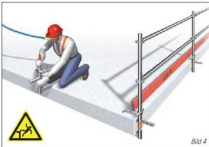
Der nächste Schritt ist das Aufstecken von Allround Stielen oder Blitz Geländerstielen auf den Rohrverbinder (bei Einsatz an der Attika) bzw. auf die Spindel (bei Einsatz an der Decke).
